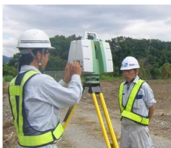
レーザースキャナによる 起工測量
