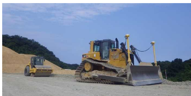
地元企業等が連携。後付け機器でICT施工を実施 ICT建機は3次元施工データーを共通化
