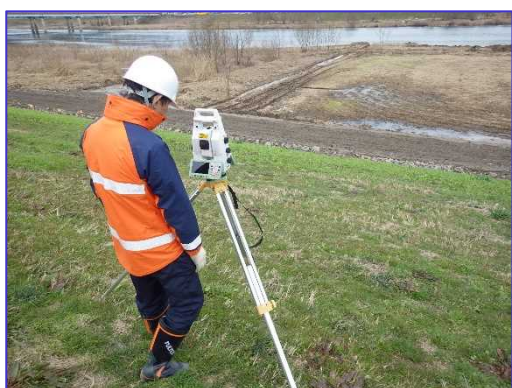
LSによる起工測量 (12月9日撮影)
