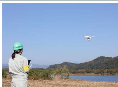
3次元起工測量の実施
