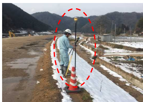
GNSSローバーを用いた出来形計測
