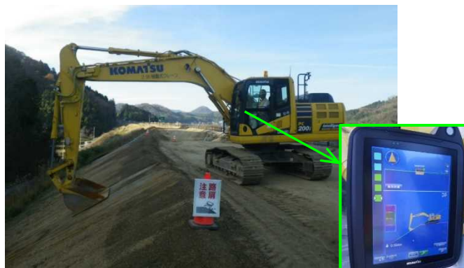
ICTバックホウによる施工
