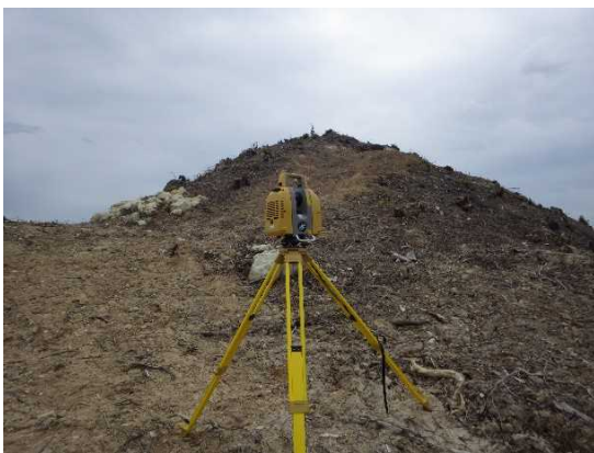
LS測量により、急斜面での作業の安全性が向上
