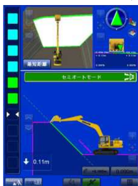
ICT(MG,MC)バックウによる切土法面整形状況
